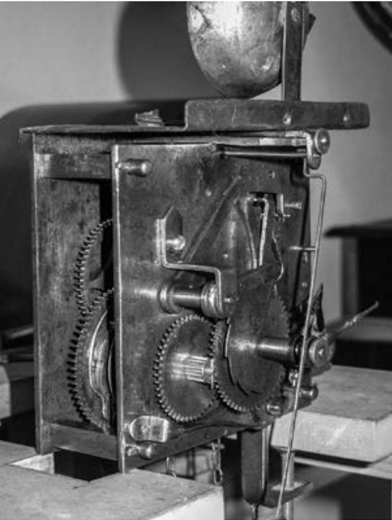
eine zu große Bohrung am Fortsatz der Vorderplatine mit Messinglot und passte die Bohrung durch Feilen genau an.
