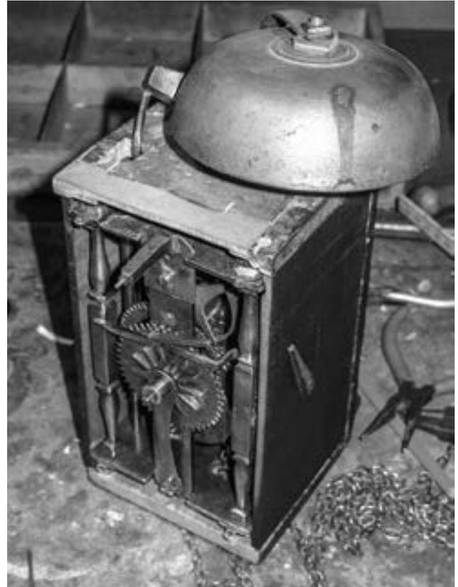
Von der Seite betrachtet fällt sofort das Eisenwerk mit profilierten Werkpfeilern auf, alle Teile gleichmäßig und nicht sehr tief korrodiert (Rost).
