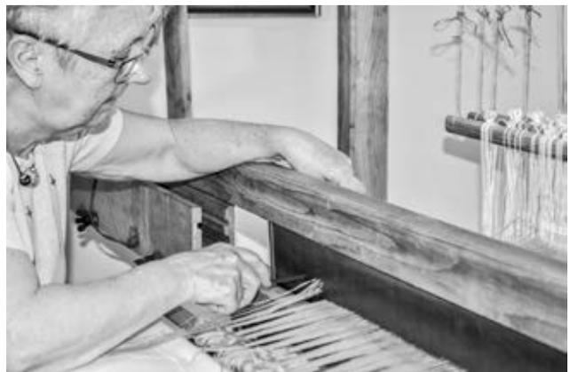
Einziehen der Kettfäden durch die Litzen, mit Hilfe einer Häkelnadel
