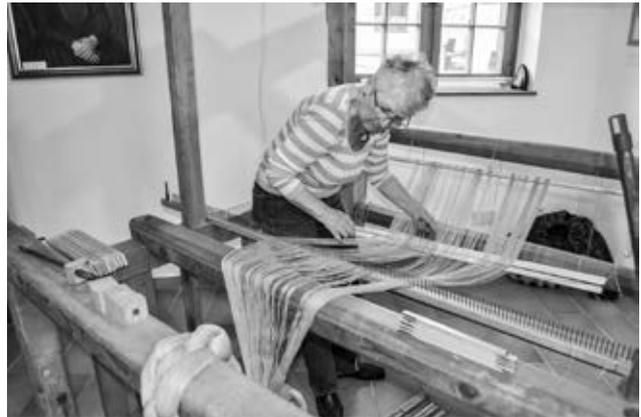
Kurz vor dem Aufwickeln der Kette auf den Kettbaum, das Einlegen der Fäden in den Reedekamm
